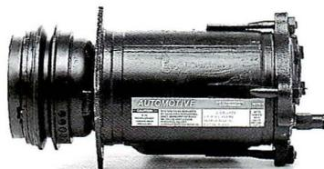
オイルパン下クラッチ側から見て2時 1V プーリー直径12.7cm スイッチ外側金属製
