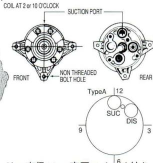
端子位置10時 端子形状ピン 6V プーリー直径11cm 高压スイッチ付き
