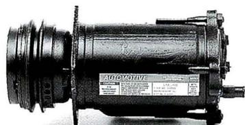
オイルパン下クラッチ側から見て2時 1V プーリー直径12.7cm スイッチ外側金属製
